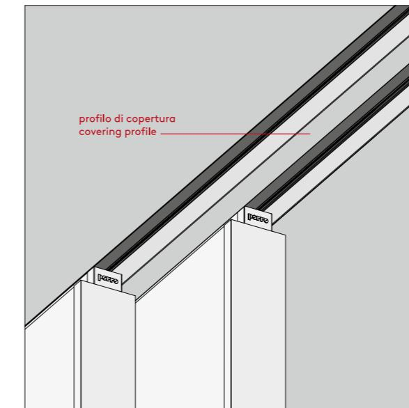
Soluzione a una via: il cartongesso copre completamente la struttura in alluminio della trave. La veletta cartongesso è predisposta per poter essere verniciata in tinta con il soffitto.
